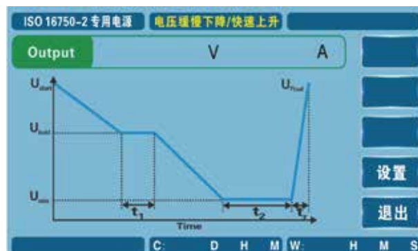
电压缓慢下降/快速上升界面显示图
